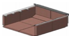
Chambre de combustion inférieure brique guide flamme installée
