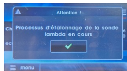
Le ventilateur d'extraction démarre et « Étalonnage Lambda en cours » apparaît sur l'afficheur
