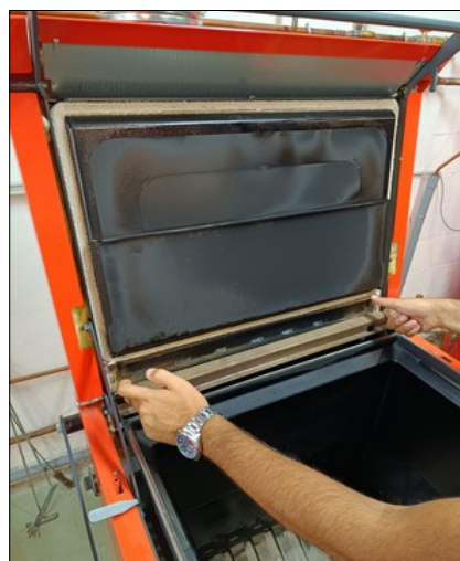
Lever la plaque pare-fumées et démonter le cache turbulateur.
