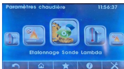
Sélectionner dans MENU -> Paramètres chaudière -> Étalonnage Sonde lambda
