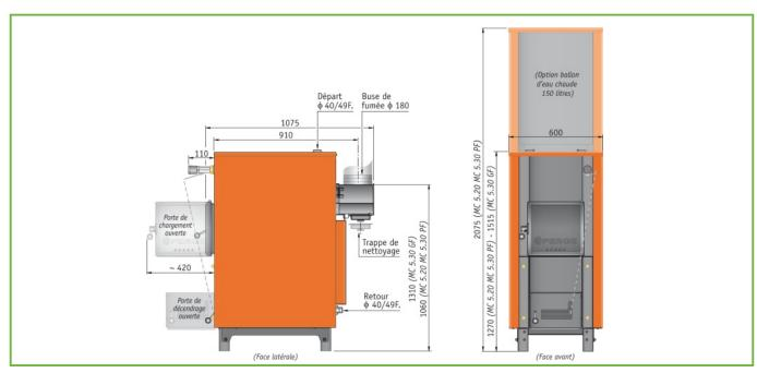
Les chaudières à bois PERGE MC CI ne requièrent qu'un faible tirage de cheminée : de 1,7 mm CE à 2,2 mmCE De plus, elles sont livrées avec un échangeur anti-ébullition monté d'usine, auquel il conviendra de raccorder une soupape de sécurité thermique pour se prémunir contre toute surchauffe. Dans ces conditions, la chaudière à bois PERGE MC pourra fonctionner sur une installation avec un vase d'expansion fermé.
